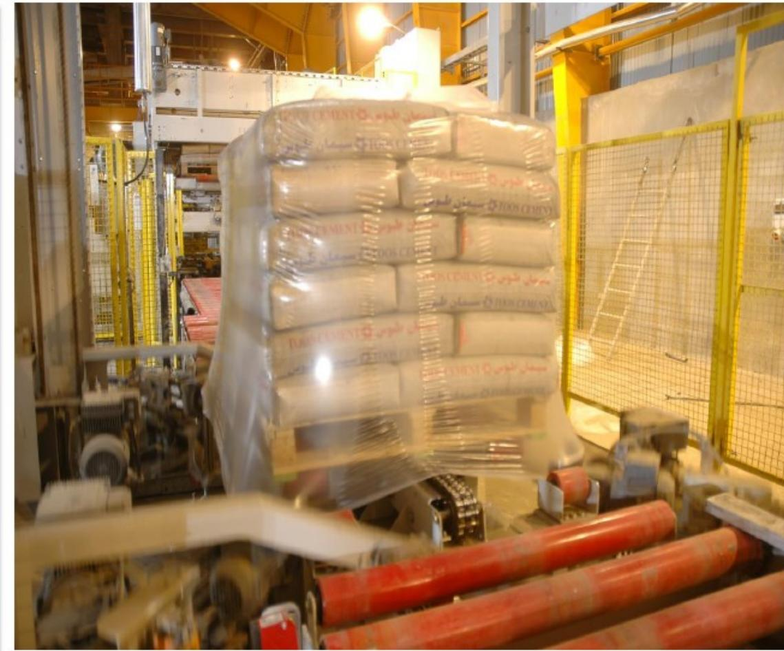
دستگاه پالاتایزر و شرینینگ در ظرفیت پالت‌های 2, 1.5, 1 تنی ساخت کمپانی آلمانی Beumer همگام با تکنولوژی روز اروپا به منظور چیدمان کیسه‌ها بر روی پالت و شرینک نمودن آن با یک فویل پلاستیکی .... .
