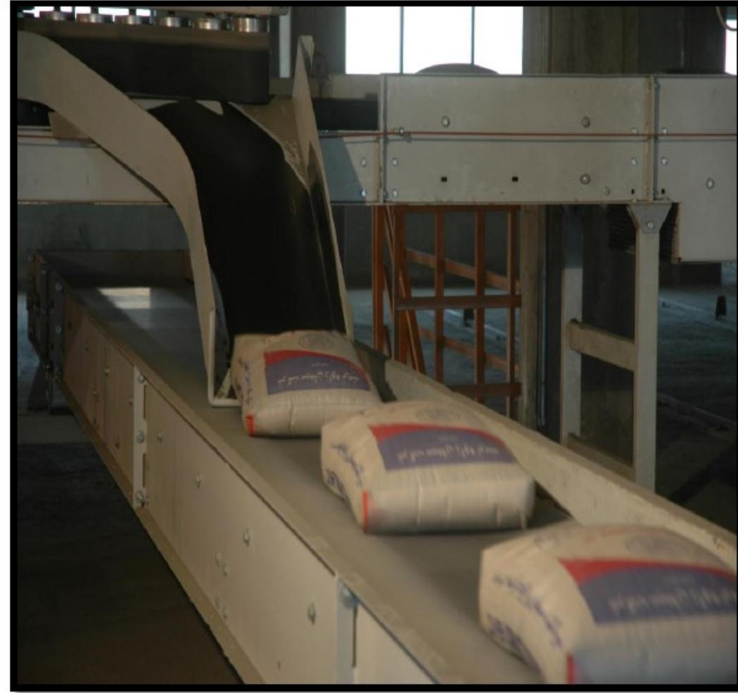
دو دستگاه اتوپک ساخت کمپانی آلمانی BEUMER برای چیدمان تنظیم و سریع پاکت های سیمان به روی ماشین بدون دخالت است که اولین نمونه استفاده شده در صنعت سیمان ایران است.
