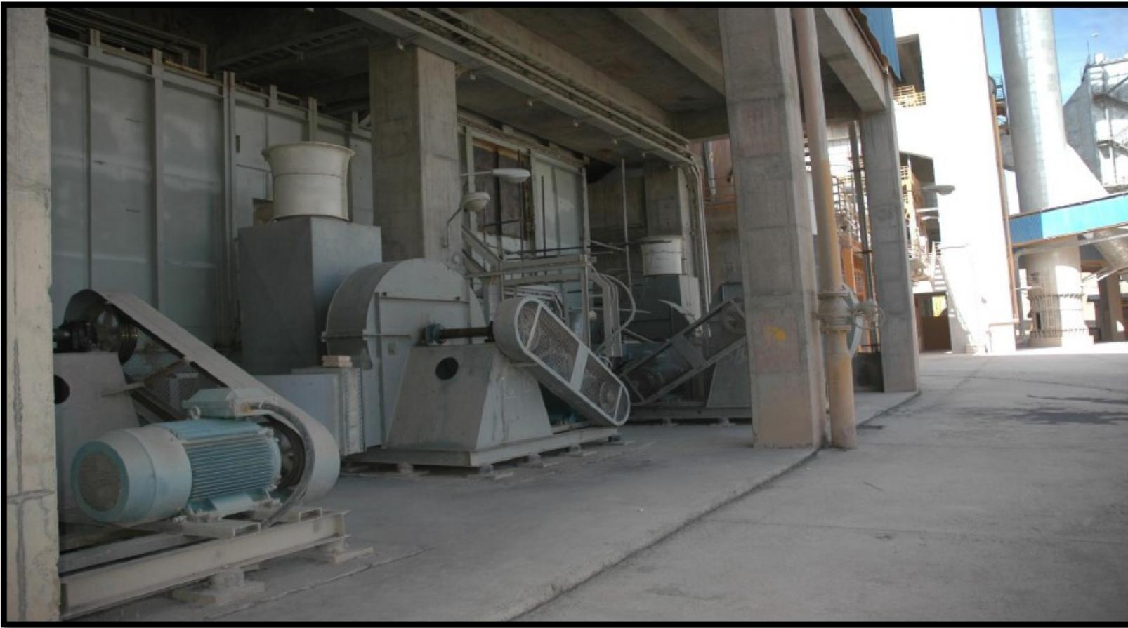
خنک کن کلینکر از نوع Pyro Floor و با ظرفیت خنک کنندگی 3500 تن کلینکر در روز و ساخت کمپانی آلمانی KHD می باشد که اولین مدل نصب شده در ایران است و سه مشخصه اصلی آن سرعت خنک کنندگی بالا و در نتیجه عدم برگشت تارهای کلینکر و دست پایی به سیمان با مقاومت فشاری بالا ، نرخ سایش پایین و در نهایت تعمیر و نگهداری اندک می باشد.
